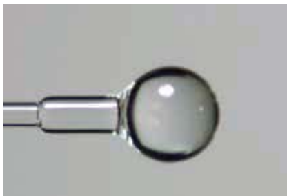
图2: 光纤准直器端部的球透镜, 对光纤出射的光进行准直、聚焦或减小发散角。
