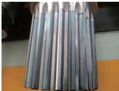
图6: 齿轮直接输出半导体激光淬火。
