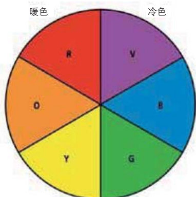
图3: 有色玻璃滤光镜用于屏蔽颜色轮中相对面的色彩时, 是最有效的。
