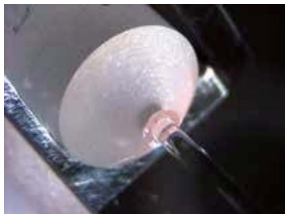
图3: 端帽 (左上) 熔接到光纤上 (右下)。
