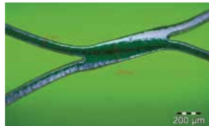
图4：利用Raydiance公司的飞秒激光平台加工的钛合金支架。加工后的支架可以直接进入抛光步骤，免去了传统加工过程所需要的多个珩磨和蚀蚀步骤。
