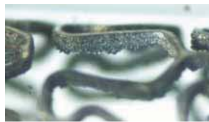
图3：用纳秒激光器加工的血管支架。图中展示了以毛刺和热影响区（HAZ）等形式表现出来的热损伤。这样的工件通常需要多个后续处理步骤以满足应用要求。
