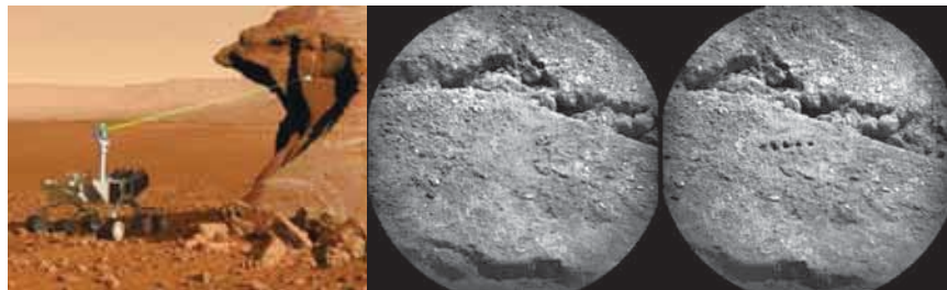
图2: ChemCam向火星岩石发射激光束,右图岩石上打出了几个小孔,根据激发的等离子体光谱分析火星岩石的化学组分。
