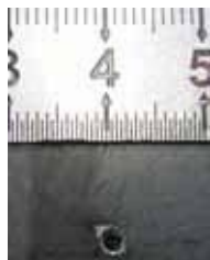
照片3: 10mm厚碳钢的高能穿孔, 耗时1s。
