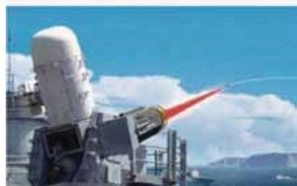
图4: 美国海军激光武器系统 (LaWS) 由六台独立的光纤激光器组成。每台激光器输出的光束通过非相干方式合束为功率33kW的输出光束。
