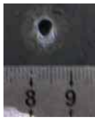
照片4: 16mm厚碳钢的高能穿孔, 耗时1.5s。
