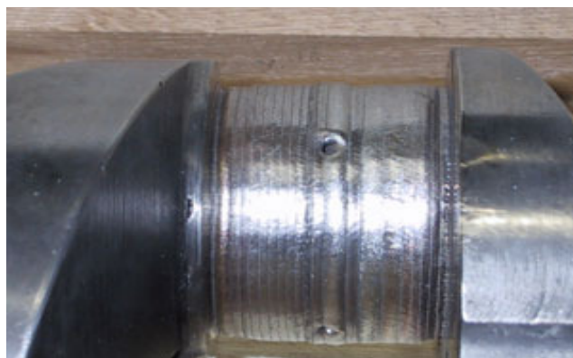
图4: 增加曲轴的耐磨性（光纤激光器实现）。
