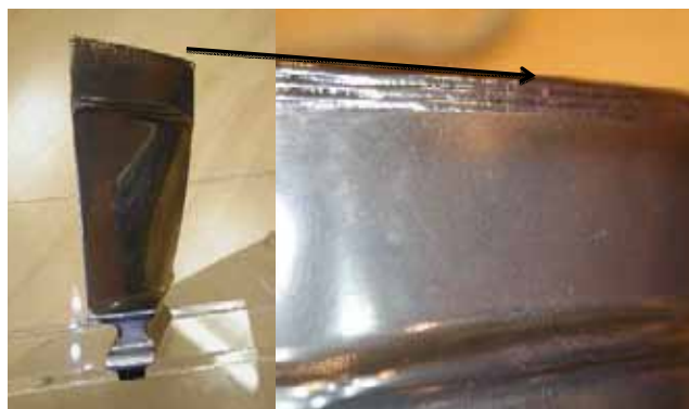
图5: 水轮机叶片修复（光纤激光器实现）。
