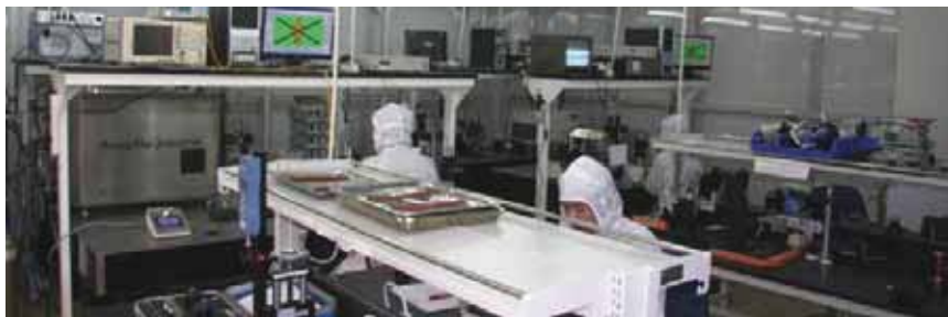
图8: 工业上基于BraggStar Industrial激光器的FBG制造设备。(图片来源: Technica SA)
