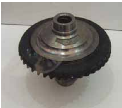
图3: 通快为宝马汽车加工的差速齿轮。
