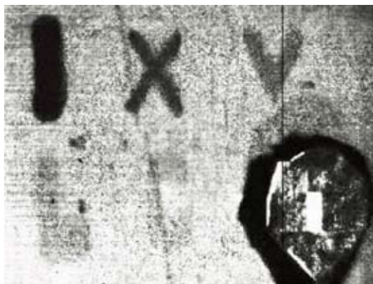
图1：图中显示了带有由血液书写的字母的聚酯织物，“I”是全浓度的血液，而“X”、“V”、“L”和“C”分别是由稀释10倍、25倍、50倍和100倍的血液书写的。该图像是使用AC（交流）调制反射的同相探测获得的。右下角显示的是用于相位探测的反射参考信号。
