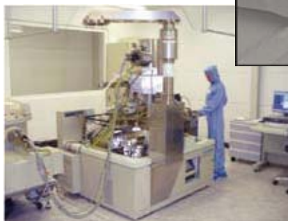
图2：采用 100\text{kV} 电子束光刻系统制造横向耦合的 DFB 激光二极管，该 DFB 激光二极管具有金属光栅结构以及厚的镀金层 (如插图所示)。
