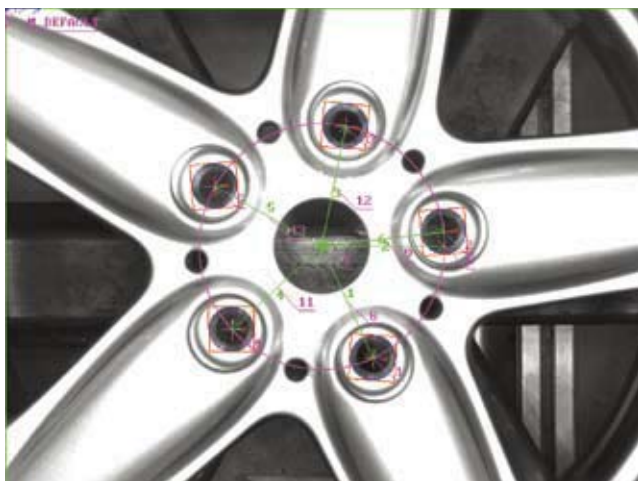
图6: Matrox Iris GT智能相机位于轮辋中心点, 计算轮辋的位置 (x,y坐标)、螺栓圆周的旋转率 (Rz) 及在校准坐标系中到相机的距离。在将坐标输出给机器人前, 智能相机将检测当前轮辋的设计是否符合预期类型。
