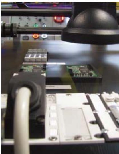
图3: Festo公司的智能相机可以直接运行很多现成的视觉应用程序, 包括条形码阅读及光学字符识别等。用户还可以采用类似PLC的编程方式对其编程。
