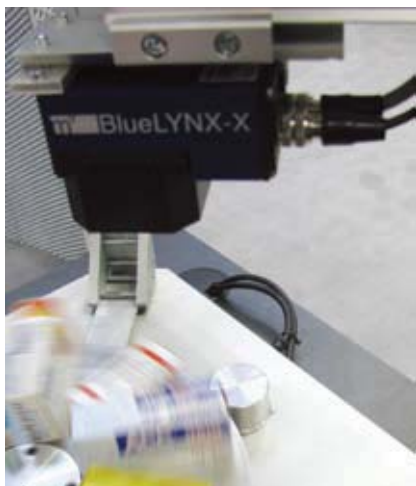
图4: Matrix Vision公司的BlueLYNX相机可以使用MVTec公司的Halcon软件进行编程。
