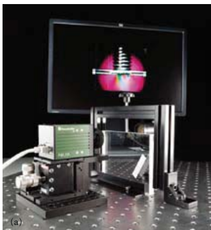
图：a) 德国弗劳恩霍夫集成电路研究所的研究人员已经使用一个定制传感器开发出了称为Polka的相机，用于取代传统偏光器中使用的分析仪。b) 为实现这一目标，一个传统的具有 1120 \times 512 像素的CMOS图像传感器被一个 2 \times 2 的偏光滤波器阵列所覆盖。
