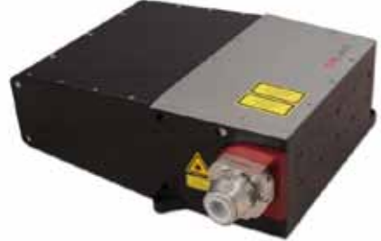
图5: 第一台 675W 原型模块, 外观尺寸为 285mm × 250mm × 100mm。
