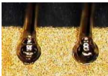
图4: 将0.004英寸直径的实心金导线焊接到镀金金属焊盘上。
