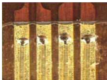
图7：将0.008英寸厚的铜扁平线到焊接到0.008英寸厚的镀铜引线框架上。
