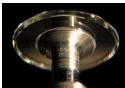
图：晶体 WGM 微腔由 CaF 2 制成，其无负载 Q 值为 2 \times 10^9 。极高的 Q 值导致明显的表面 Rayleigh 背散射，使得微腔能够耦合到分布反馈半导体激光器中，进而将激光线宽降至 200Hz 以下。
