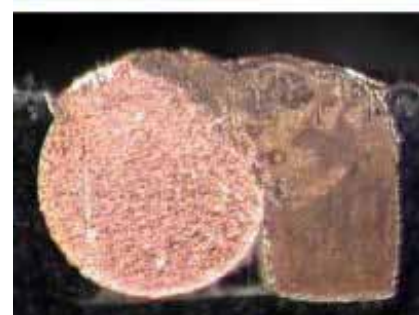
图6: 0.016x0.09英寸镀金铜引线与直径0.016英寸的镀银铜线之间的小焊缝焊接。
