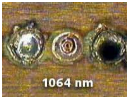
图2：分别使用1064nm和532nm的脉冲Nd:YAG激光在铜条上进行点焊。
