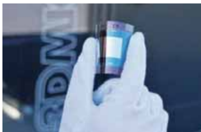
图3：由超短脉冲激光加工的有机太阳能电池膜层。
