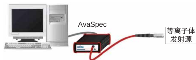
图5：等离子体特征谱线测量实验布局图。
