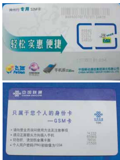
图4：用30W光纤激光打标机标记的手机卡。
