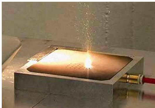
图2：罗芬的StarDisc碟片激光器用于太阳能电池打孔应用。
