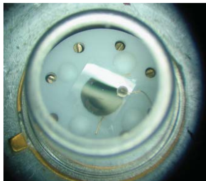
图2: 目前薄膜LiTaO 3 热电探测器已有商用产品。
