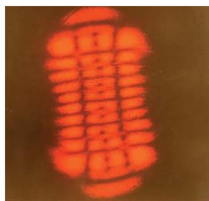
图 1：贝尔实验室的第一台红光氦氖激光器产生的惊人高阶模图像。
