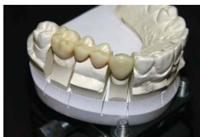
图: 在制造过程中, 将数字光处理技术与激光辅助制造技术协同使用, 通过改变逐个像素的照明强度 (以及相应的固化深度), 快速成型制造过程可以加速牙科和助听器植入设备的制造过程。
