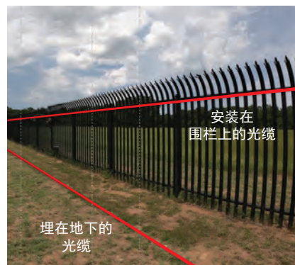
图4: 光纤传感系统很小, 可以沿着现有的周边基础设施进行离散掩埋或放置。
