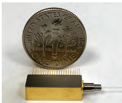
图2: 集成SOA的基于可调谐激光器的收发器的小型化封装, 以满足通信设备的小尺寸要求。该器件封装后的尺寸为14mm × 5mm × 4mm。
