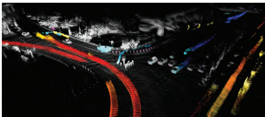
图3: 在这两幅图像中,Blackmore公司开发的激光雷达系统显示了从接近(蓝色)到远离(红色)和静止(白色)的色谱上的瞬时速度;几秒钟的累积数据揭示了行人和交通模式。
