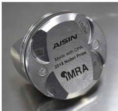
图4：一家主流汽车制造商生产的飞秒激光纹理加工的活塞；表面纹理应用于裙边区域，以减少摩擦，提升润滑功能。
