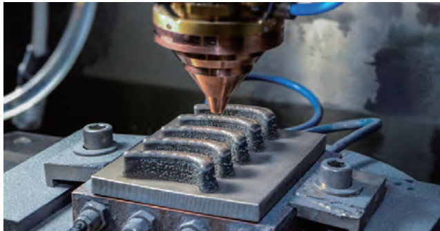
图1：通过激光粉末堆焊，可以将不同材料制成的部件进行整体制造，从而使特定材料能够准确地放置在要求其性能的地方。如图中就为燃气轮机提供了更轻、更好、成本更低的叶片。
