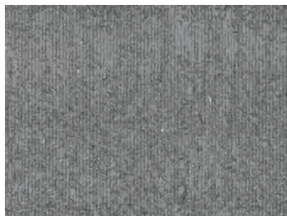
图 5: 激光光丝在厚度为 0.5mm 的蓝宝石中形成一系列平行空隙。
