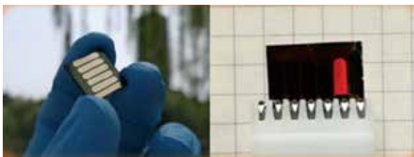
左：反式结构钙钛矿太阳能电池。右：电池器件在正向电压（2V）下的发光照片（表明电池器件具有较低的非辐射复合能量损失）。
