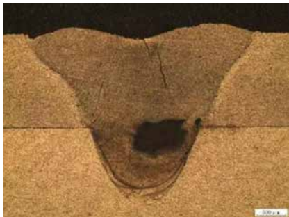
a: 脉冲激光器铝合金点焊焊点金相
