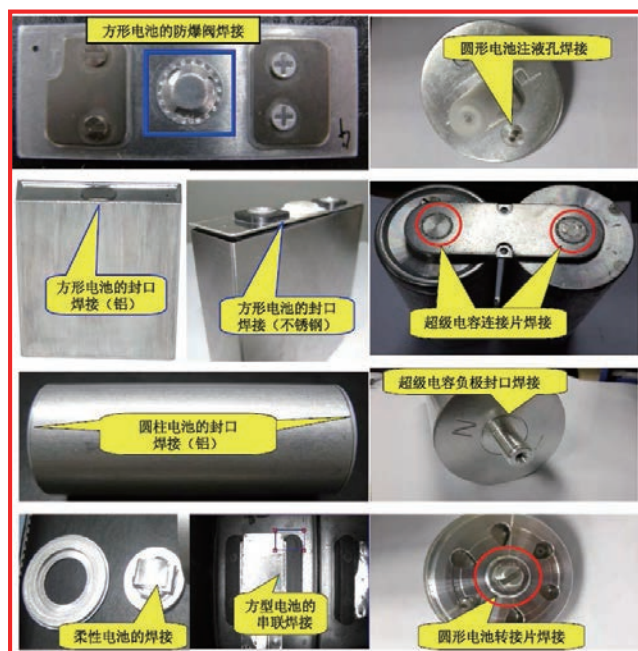
图5：各种电池的激光焊接焊接部位。
