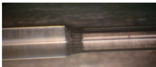
图9：20/400光纤PCS-100剥除断面。
