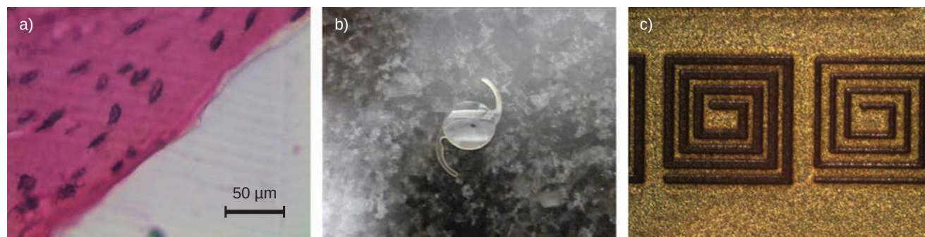
图1: 采用Menlo Systems公司的BlueCut微焦飞秒光纤激光器，切割的骨骼样品的剖面图 (a)，在聚甲基丙烯酸甲酯 (PMMA) 内制备的人工晶体 (b)，以及微波应用的金螺旋 (c)。
