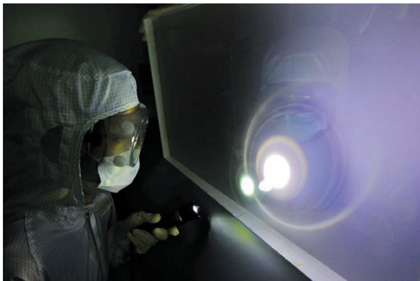
图 1: 用于 SG II-UP 系统的大口径偏振片 (对角线尺寸达 900mm)。
