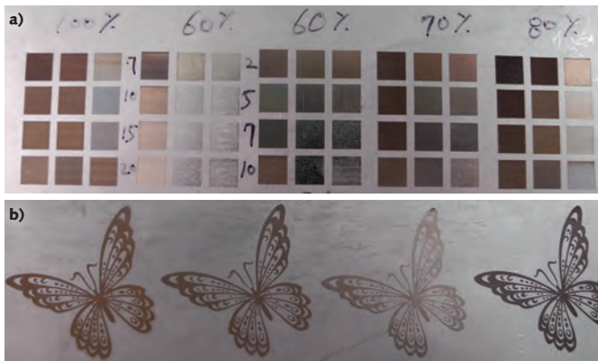
图1: 对峰值功率、打标速度和脉冲个数的精确控制，能够实现具有大量细节的不锈钢彩色激光退火（打印）。这里显示了一些可获得的颜色 (a) 和复杂图案的高印刷质量 (b)。
