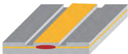
图6: 宽波导高功率激光器示意图。
