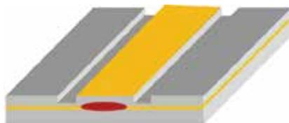
图5: 宽波导高功率激光器示意图。
