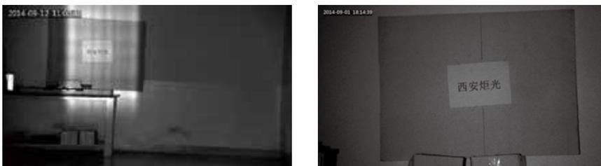
图4: 时域积分动态匀化后照明效果对比(左:非匀化光直接照明;右:匀化光照明)。
