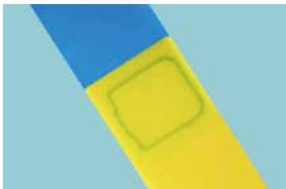
图7: 激光塑料轮廓焊接。
