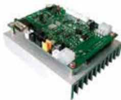
目前市场上各类单管或多单管光纤耦合激光器使用，集“LD 驱动电源、红光指示驱动电源、TEC 控制电路”等多种功能于一体，已大量应用于祛红血丝、牙科等医疗领域。
