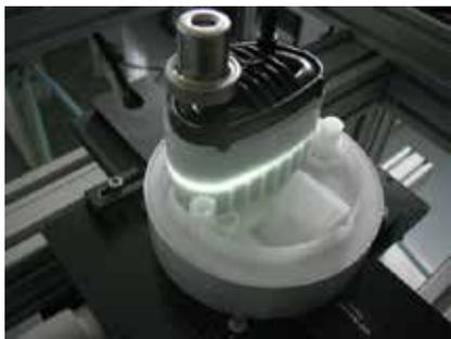
图10: 激光同步焊接燃料泵。
