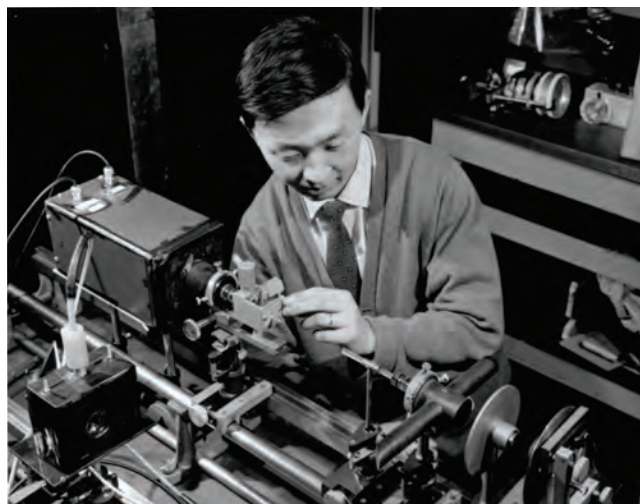
图1：高锟在Standard Telecommunications Laboratories测量块体石英的衰减。
