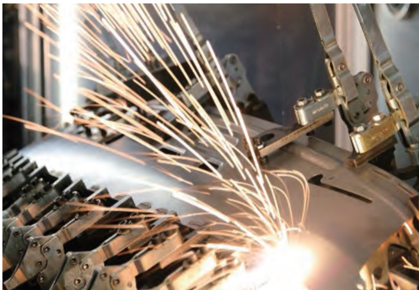
图4：用4 kW光纤激光器进行汽车零部件的扫描焊接。
