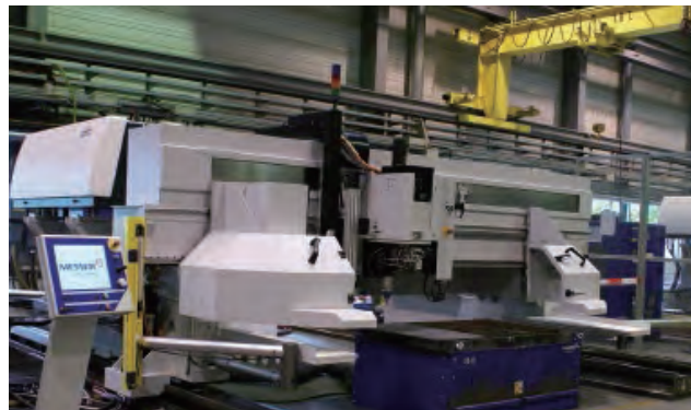
图3：七十年代初期的Messer切割系统：激光源倾斜45°。这使得用户通过使用一个相移延迟90°的光束弯曲装置，在工件上获得圆偏振光（左图）。2014年的Messer切割系统：配备4.5 kW CO 2 板条激光器的大型系统。所有Rofin的CO 2 激光器发射与水平面成45°的偏振光束（右图）。
