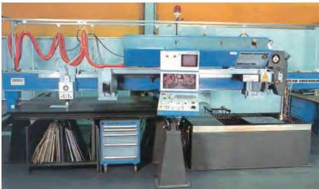
图3：七十年代初期的Messer切割系统：激光源倾斜45°。这使得用户通过使用一个相移延迟90°的光束弯曲装置，在工件上获得圆偏振光（左图）。2014年的Messer切割系统：配备4.5 kW CO 2 板条激光器的大型系统。所有Rofin的CO 2 激光器发射与水平面成45°的偏振光束（右图）。
